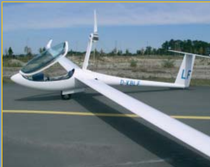
LEISER AUFTRITT: Die Antares in Motorflugkonfiguration. Eine Batterieladung sichert ihr 3000 Steigmeter
